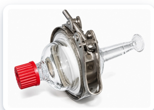
Nouveauté en option : ensemble porte-filtre avec plaque téflon percée de trous Ø 1
