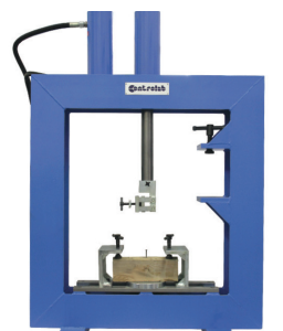
SDB3614/1 - ESSAI D'ARRACHEMENT SDB3606/1 - ESSAI DE CISAILLEMENT SUR BOIS
