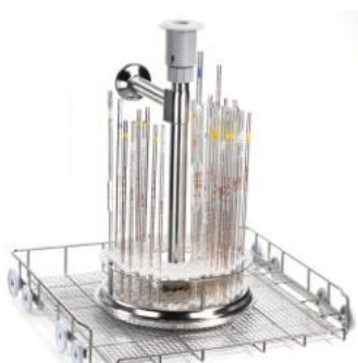
LPT100 Lave-pipettes spécial pour le lavage de 100 pipettes d'une capacité de 1 à 20 ml. Hauteur maximale 45 cm. Code: 5800278
