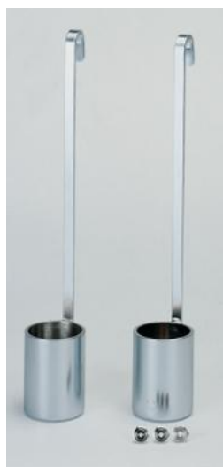
Coupes à anse. Modèles DIN 53211 N° 4 et Ford ASTM D-1200.
