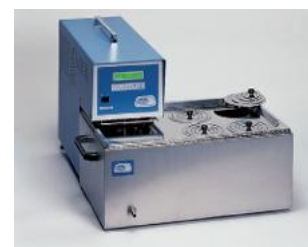
Unité thermostatique avec bain intégré et couvercle à 4 orifices.
