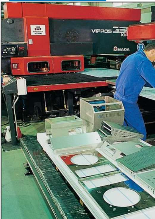
Unité de découpe et de poinçonnage à commande numérique, et découpe laser.
