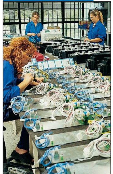
Assemblage et montage des éléments électroniques ainsi que des systèmes de régulation et de contrôle.
