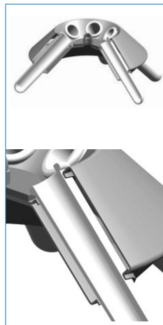
Vue longitudinale du rotor avec enveloppant et double appui du gaine dans ses deux extrémités.
