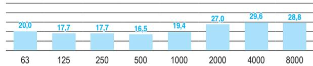
Port sous le menton. EN 352-2: SNR 24dB (H:26dB M:20dB L:18dB)
