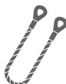
Les longues sont des éléments de liaison, elles peuvent intégrer un absorbeur d'énergie. Cet élément permet d'amortir le choc en cas de chute. Dans ce cas, cet équipement est couvert par la norme EN 355.
