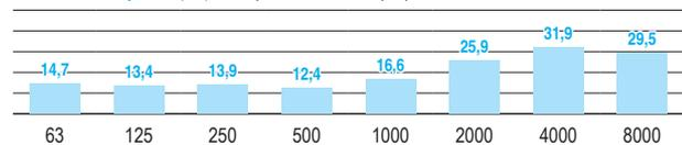
Port sous le menton. EN 352-2: SNR 21dB (H:24dB M:16dB L:14dB)
