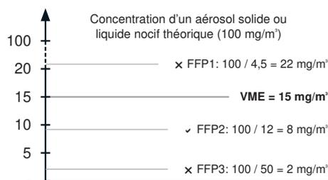
Pour cet exemple, le masque FFP2 est le plus adapté. Le FFP1 n'apporte pas une protection suffisante alors que le FFP3 surprotège l'utilisateur. VME = valeur moyenne d'exposition. C'est la valeur limite d'un gaz ou d'une poussière (exprimée en ppm ou mg/m<sup>3</sup>) à laquelle un individu peut être exposé durant une journée de travail (8h/jour) durant toute sa vie professionnelle, sans risque pour sa santé. APF = facteur de protection attribué.
