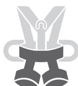
La ceinture à cuissardes est un élément en textile enveloppant la taille, relié à chaque jambe et muni d'un point d'accrochage ventral, permettant la suspension d'une personne.
